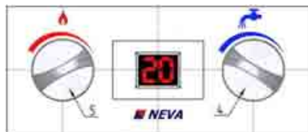
Рисунок 9 Положение ручек перед включением аппарата
