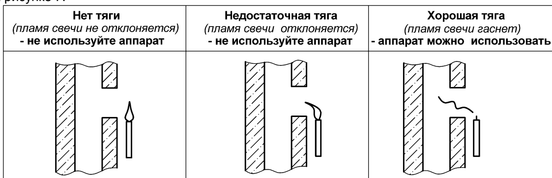
Рисунок 7. Способ проверки тяги в дымоходе
